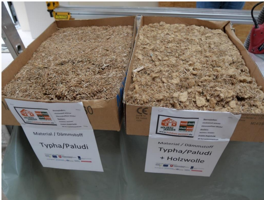
Abbildung 3: Einblasdämmmaterialien aus breitblättrigem Rohrkolben. Links: Reines Material aus Rohrkolben. Rechts: Mischung aus reinem Rohrkolben und Holzwolle (Foto: 3N)
