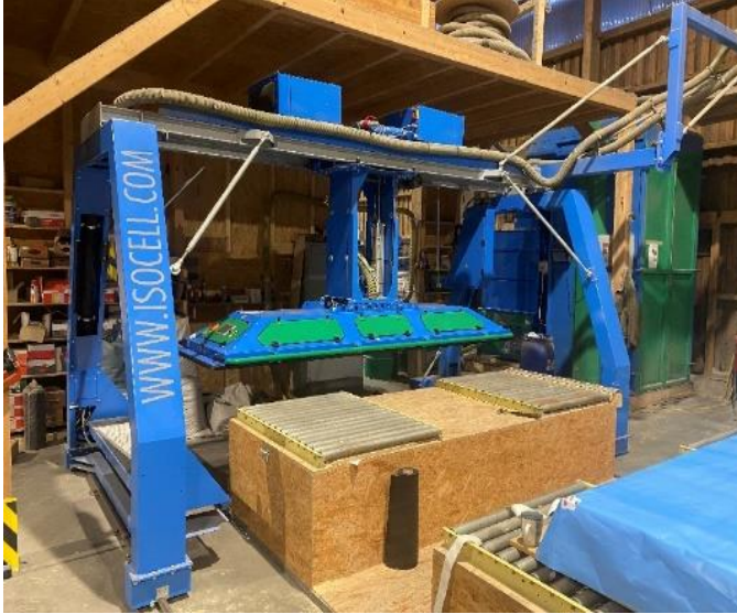
Abbildung 1: Isocell-Anlage mit Isoblow Elements Einblasplatte (Foto: Janssen)
